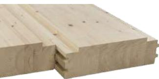
**Planchers lamellé-collé :** c'est une structure primaire pré-taillée, composée de poutres porteuses, de sommiers, de poteaux et de trémie d'escaliers accompagnée par des dalles lamellé-collées de largeur 600mm et d'épaisseur 100->140mm. Ce plancher peut rester en sous face apparente et sa mise en œuvre est rapide (12 dalles pour 60m<sup>2</sup>).
